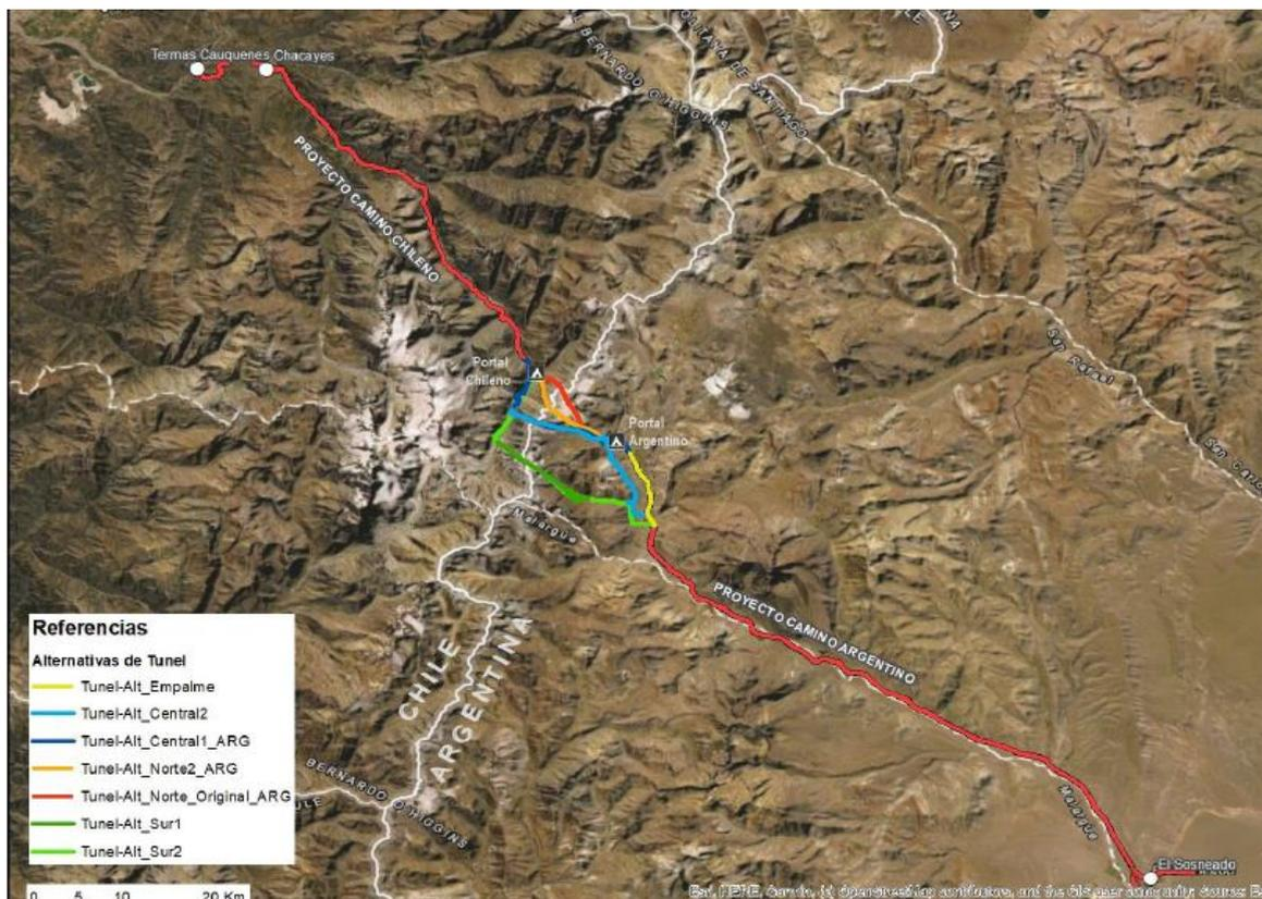
En el estudio se fijaron los puntos para la ubicación de los portales y se propusieron dos trazados de ejes geométricos para el túnel. Ambos ejes se plantearon con pendiente ascendente hacia Argentina, y consideran una única alternativa para el emplazamiento del portal chileno y dos posibilidades de ubicación para el portal argentino, denominados como opción N°1 y opción N°2.
