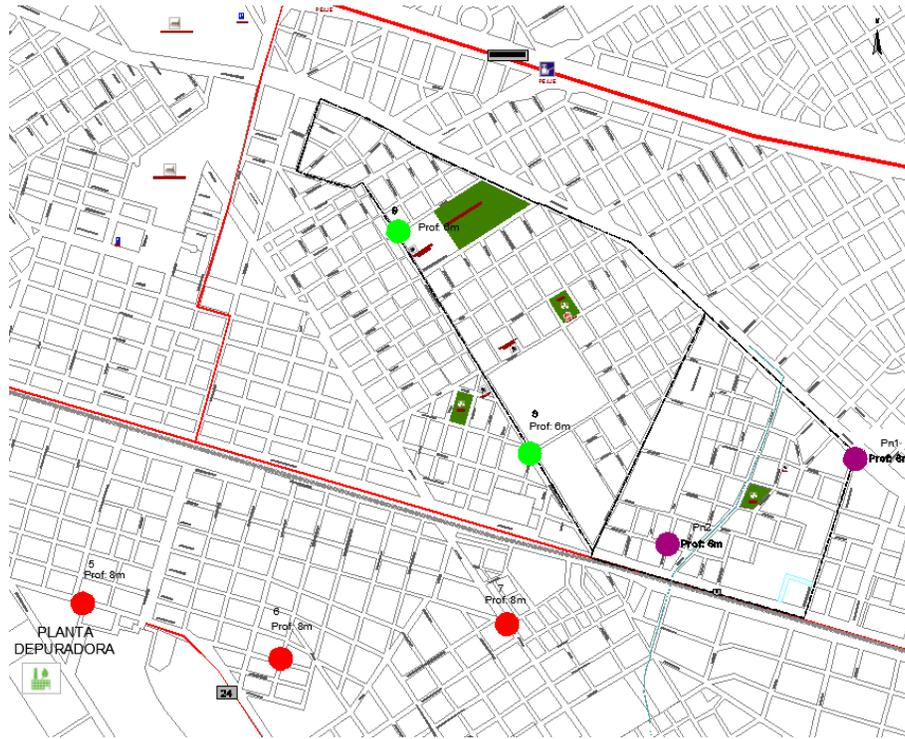
Figura 15. Ubicación Perforaciones – Estudio Geotécnico Zona 4
