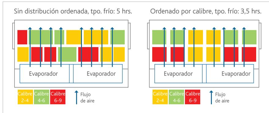
sistema ayudara a los productos a alcanzar a esa temperatura. Esto permitió ahorrar energía de refrigeración y de movimiento de aire.
