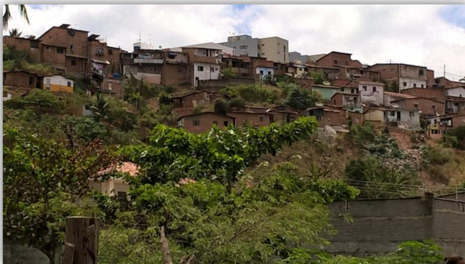
**Figura 16:** Encosta situada na AID do projeto. Esta área possui altimetria entre 44 e 55m e declividades superiores a 30°, podendo ultrapassar os 60°. São áreas densamente ocupadas por populações de baixa renda que sofrem com a alta suscetibilidade a escorregamentos nos períodos de chuva a mais de cinco décadas.
