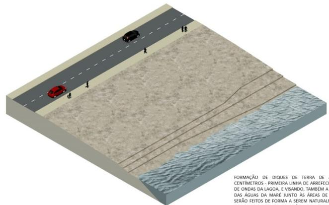
FORMAÇÃO DE DIQUES DE TERRA DE APROXIMADAMENTE 30 CENTÍMETROS - PRIMEIRA LINHA DE ARREFECIMENTO DO MOVIMENTO DE ONDAS DA LAGOA, E VISANDO, TAMBÉM A RETENÇÃO TEMPORÁRIA DAS ÁGUAS DA MARÉ JUNTO ÀS ÁREAS DE PLANTIO (ESSES DIQUES SERÃO FEITOS DE FORMA A SEREM NATURALMENTE DESMANCHADOS, AO LONGO DO TEMPO, PELAS ÁGUAS FLUTUANTES);
