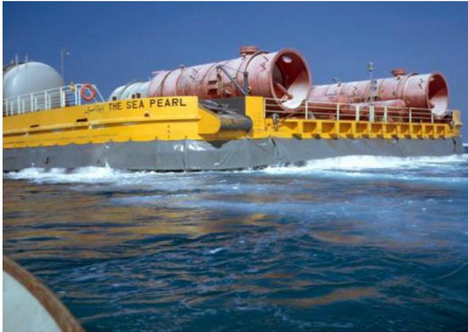
**Figura II.7.** Imagen que muestra un *hovercraft*, transportando material pesado.
