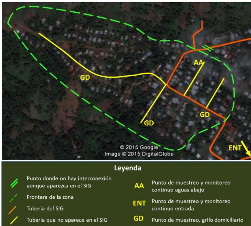
Figura 4. Esquema de la zona AL. El punto ENT, donde se midieron la presión y caudal de entrada, está ubicada aproximadamente 1 km al sureste, afuera, de la esquina inferior derecha del croquis. EB-2000, donde se hicieron muestras puntuales y el monitoreo continuo de presión, cloro y turbiedad, está ubicada aproximadamente 400 m al sur (aguas arriba) del punto ENT.
