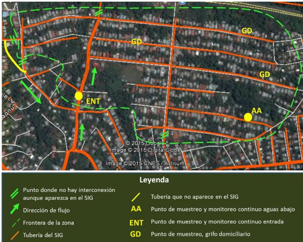
Figura 3. Esquema de la zona 7S. Hay algunas diferencias entre la configuración de la red en la base de datos SIG del IDAAN y la configuración de la red, según las investigaciones de campo que se hicieron para averiguar si la zona estaba aislada (Anexo A).
