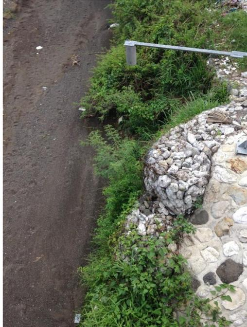
**Photos 4 : capteur radar sûr au bout d'une perche devant le pont sur la Rouyonne près de Léogane. Le cône de mesure du capteur donne partiellement sur la paroi de son socle et le fond est parsemé de végétation ce qui perturbe la mesure. La perche supportant le capteur devrait être rallongée.**
