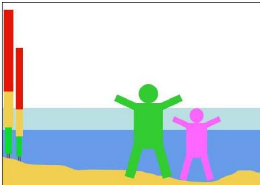
Figure 17 ; principe de perches repères des niveaux de crue dangereux pour les piétons proposé en 2007 par BRL (Réf. 3).
