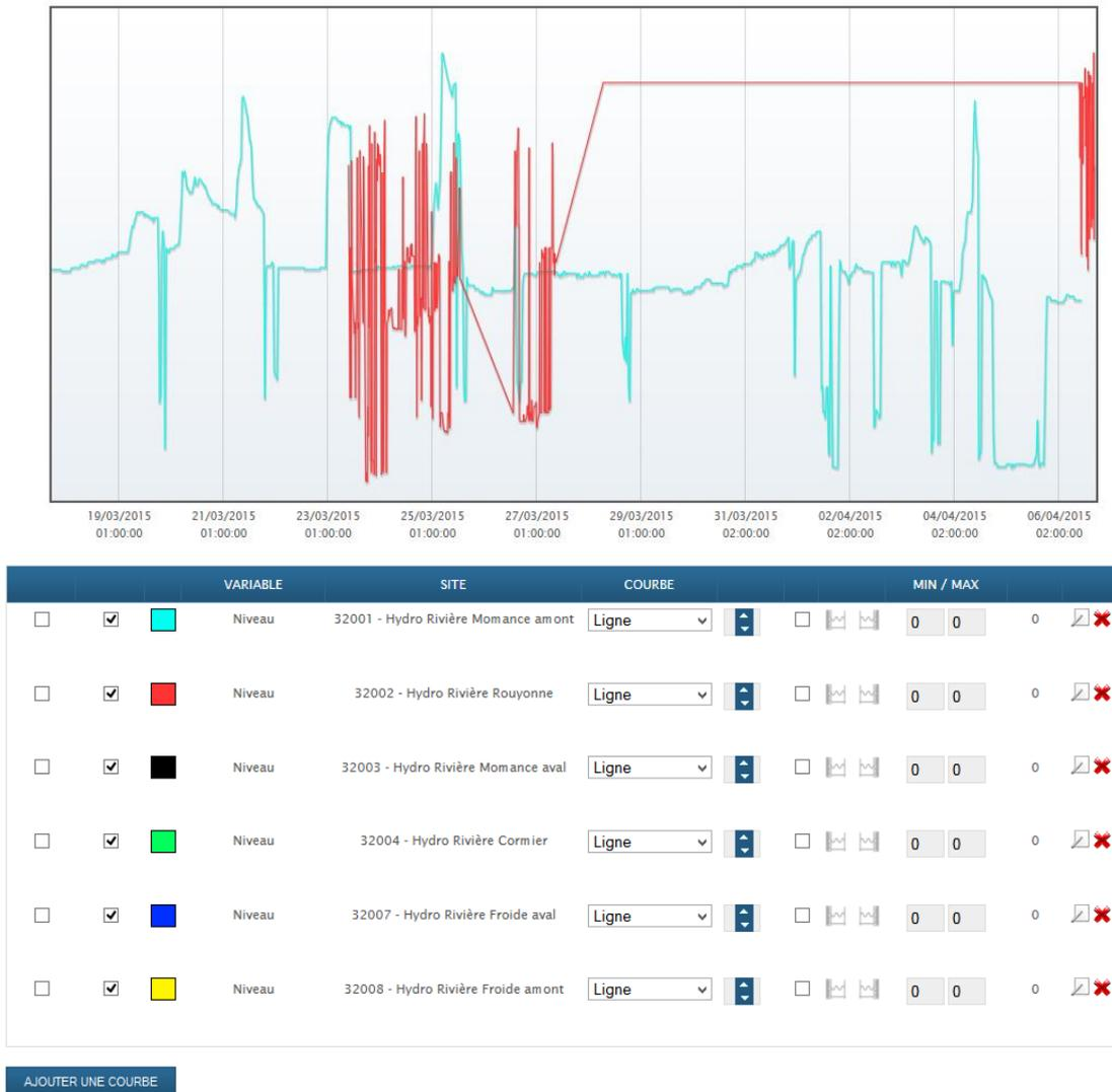
Figure 11 : interface e-vigilance montrant les niveaux mesurés par les différents capteurs dans le BV Momance/Rouyonne, Rivière froide, inondant la plaine de Léogane à la date du 6 avril 2015.
