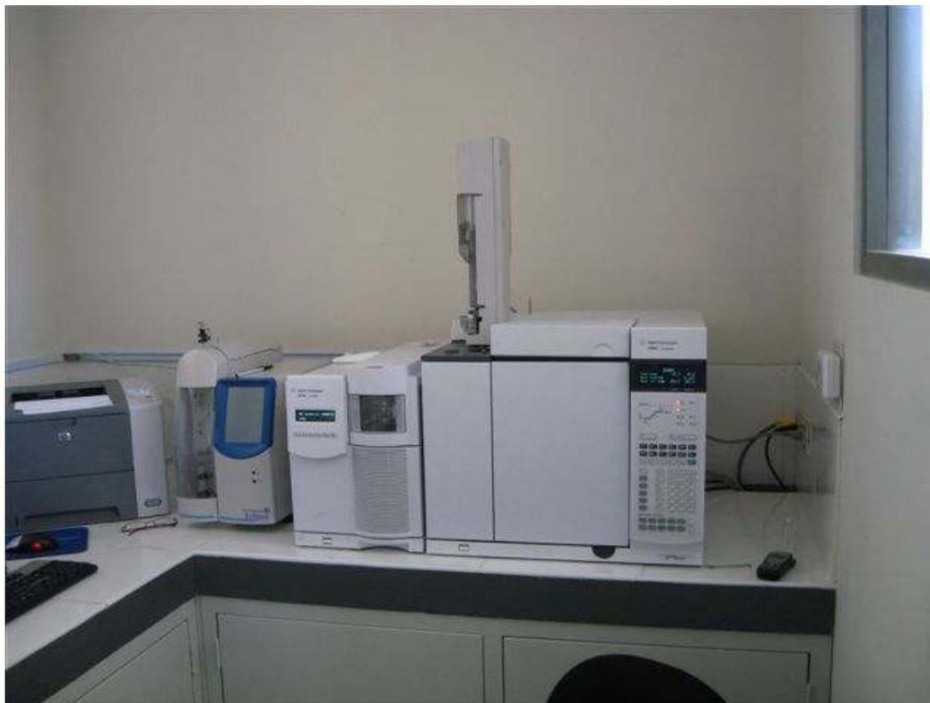
Foto 2: Instrumentos para analizar hidrocarburos con detectores fid y ms; laboratorio de Lurín.
