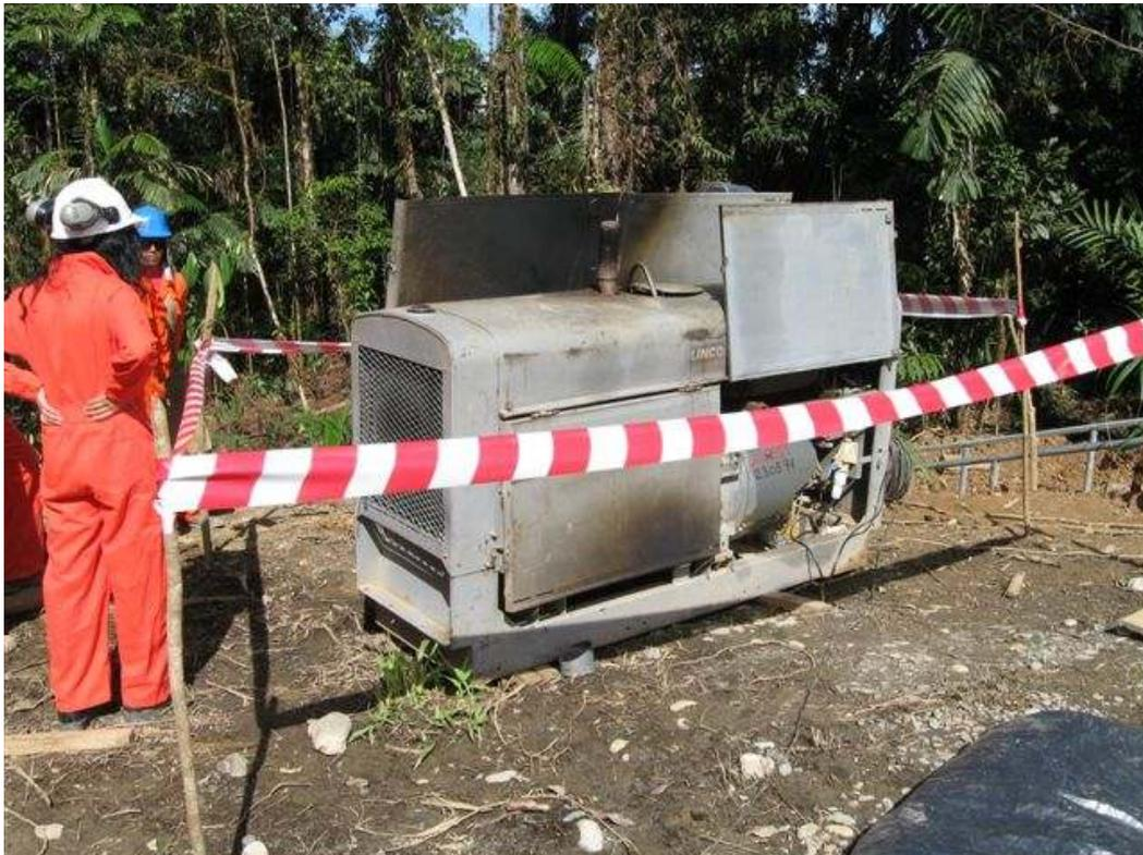
Foto 16: Maquina de soldar accionada con motor diesel que no estaba sobre contención impermeable para contener eventuales filtraciones de lubricantes y combustibles.
